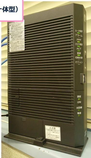
写真は、ONU一体型ホームゲートウェイ (PR-500MI)です。LANケーブルでパソコンと接続して設定を行います。
