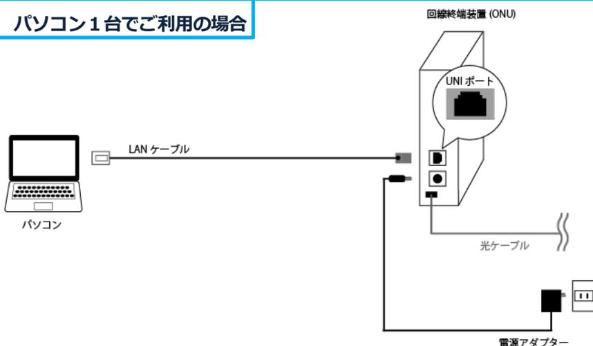
ひかり電話をご利用でない場合は、「回線終端装置（ONU）」と「パソコン」をLANケーブルで接続します。
